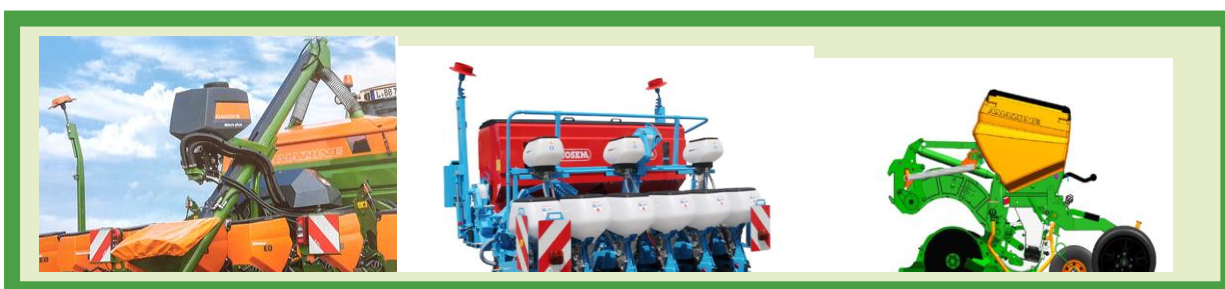
Abbildung 1: Pneumatischer Mikrogranulatstreuer (links) installiert an einer Einzelkornsämaschine des Herstellers Amazone (WILHELM, 2015, S. 38 f); mit mechanischen Antrieb (mitte) des Herstellers Monosem (MONOSEM, 2013). Schematische Darstellung der Applikation von Mikrogranulaten am Einzelkornsächar (rechts verändert nach PLESSER, 2016).
