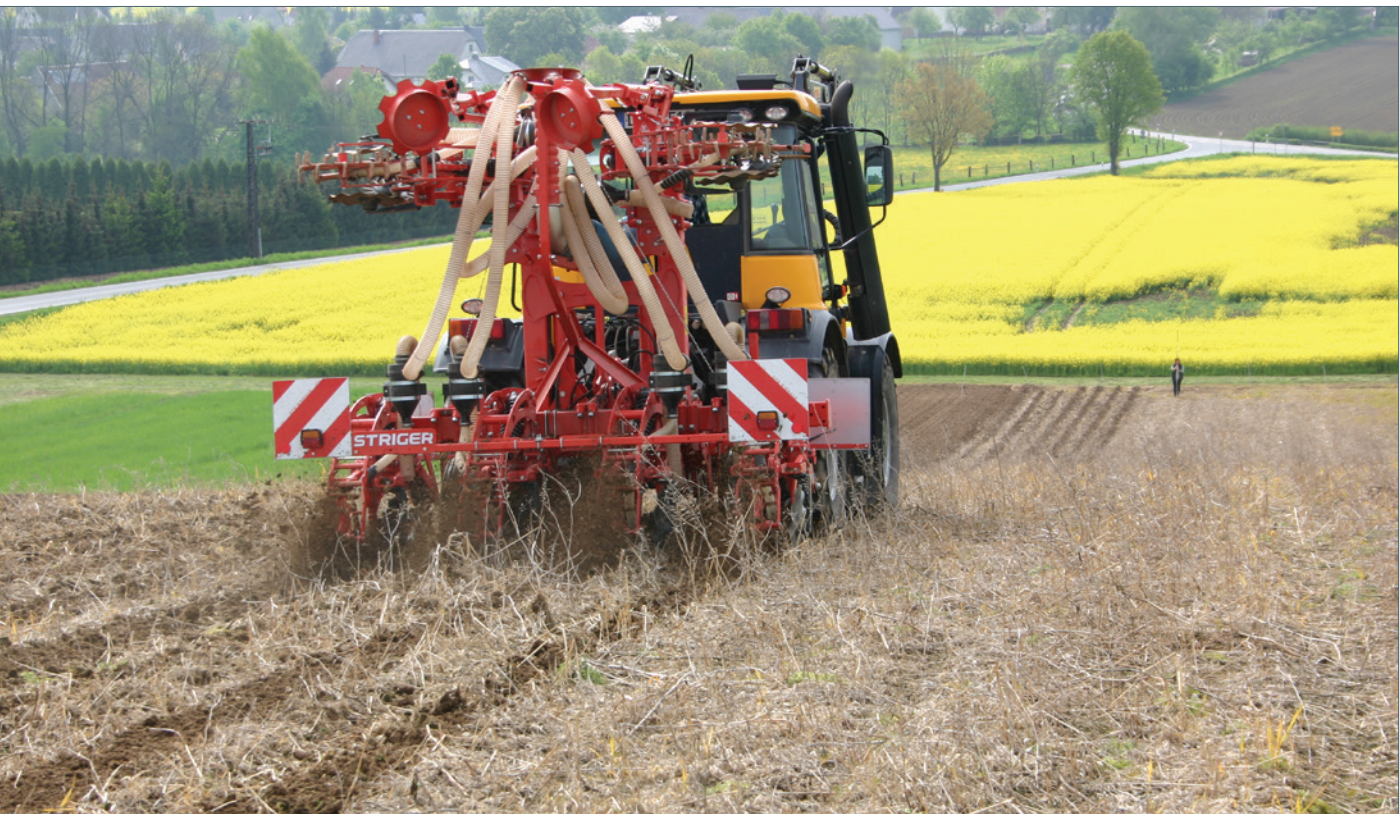
Abb. 8: Streifenbearbeitung vor der Maisaussaat (Foto LfULG)
