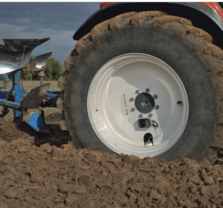
Abb. 2: Ultraschallsensor in der Felge beim Pflügen (Foto: Ortmeier, TI)
